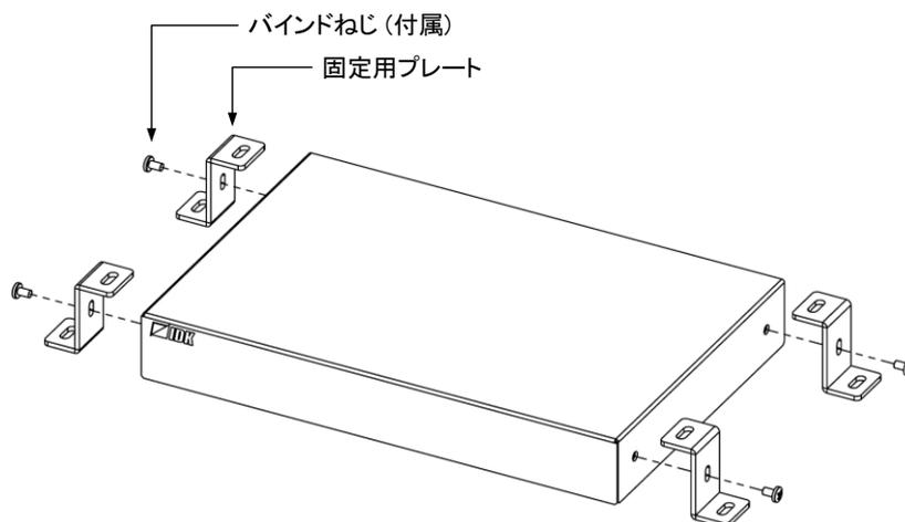
[図 2] 固定用プレートの取り付け
