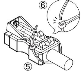
④ ねじを締めて固定ブラケットを固定する (締めすぎに注意)。
