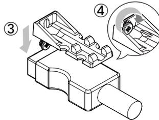
③ 固定ブラケットを HDMI コネクタ上部のねじに引っ掛け、固定ブラケットを HDMI ケーブルに密着させる。
