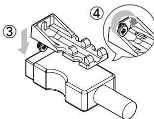
③ 固定ブラケットを HDMIコネクタ上部のねじに引っ掛け、固定ブラケットを HDMI ケーブルに密着させる。
