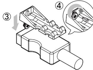
③ 固定ブラケットを HDMI コネクター上部のねじに引っ掛け、固定ブラケットを HDMI ケーブルに密着させる。
