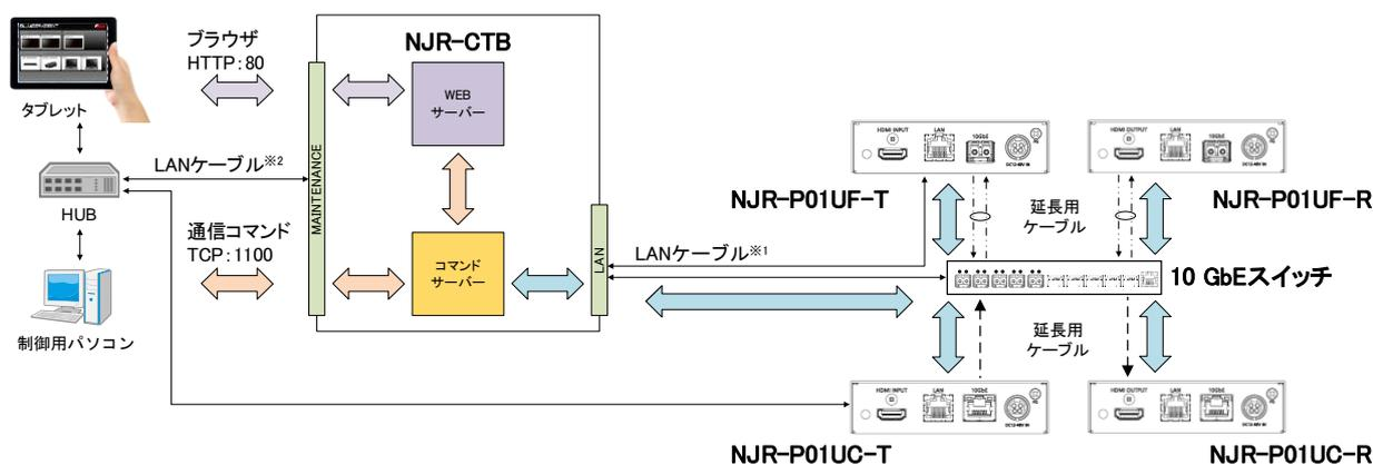
※1 NJR-CTBのLANコネクタは、NJR-P01UF/C-T/RのLANコネクタまたは10 GbEスイッチのいずれかに接続します。
