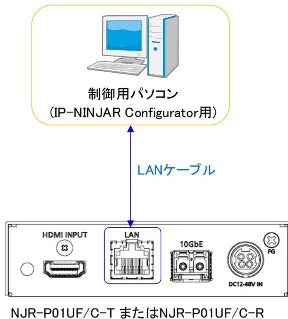
**[図 3.3] LAN ケーブルの接続**
