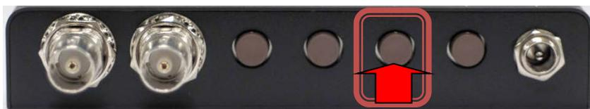
アスペクト比は左から三番目のボタン 3 を押して設定、変更します。出力フォーマット設定のウィンドウが画面右上に表示されているときは、ウィンドウがアスペクト比設定に変わるまでボタンを長押ししてください。
