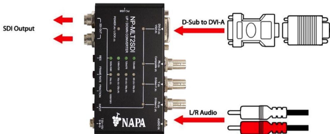
※右側の各信号のコネクタ形状は一例です。NP-MLT2SDI に適したコネクタへ変換して接続してください。
