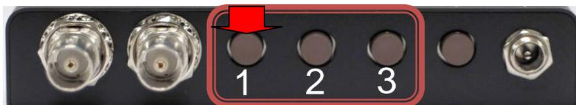
フレームレートを設定する時は、ボタン1を押して出力フォーマット設定のウィンドウが画面右上に表示されてからボタン2や3を押してください。
