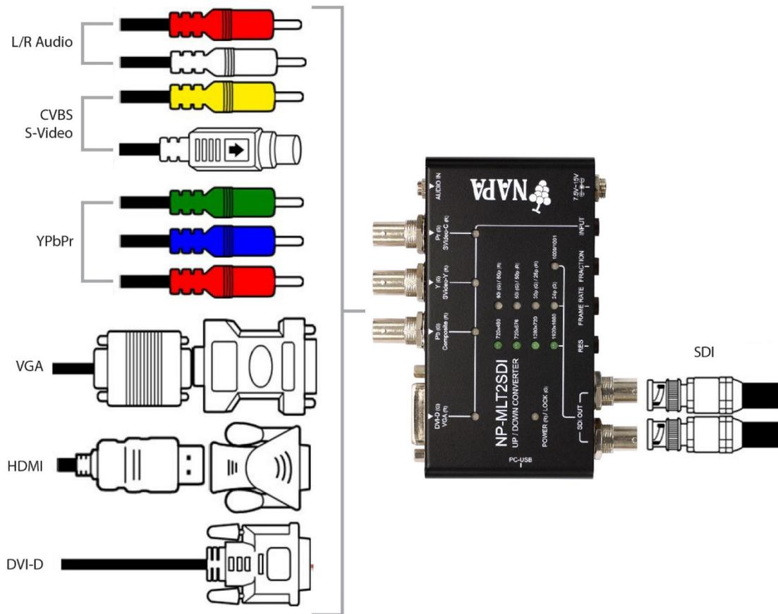
※左側の各信号のコネクタ形状は一例です。NP-MLT2SDI に適したコネクタへ変換して接続してください。
