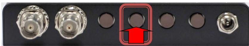
音声モードは左から 2 番目のボタン 2 を操作し選択、変更します。出力フォーマット設定のウィンドウが画面右上に表示されているときは、ウィンドウが音声モードに変わるまでボタンを長押ししてください。
