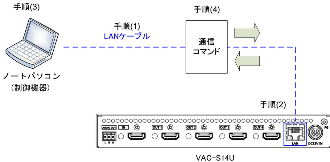
[図 2.2] LAN 通信による制御
